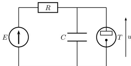
**Données :** Tension d'alimentation  $E = 120\text{V}$ , résistance d'alimentation  $R = 1,0 \cdot 10^2 \Omega$ , résistance du tube allumé  $R_T = 1,0 \Omega$ , capacité du dispositif  $C = 5,0 \cdot 10^{-7} \text{F}$ . Tension d'allumage  $U_a = 90\text{V}$ , tension d'extinction  $U_e = 72\text{V}$ . On n'hésitera pas tenir compte de ces valeurs numériques pour simplifier certaines des expressions obtenues.
